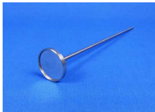
Fot. 19.10. Przykład mocowania – kotew i metalowy dysk do mocowania sfery referencyjnej
