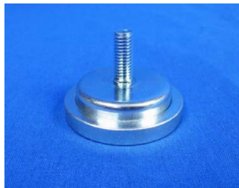
Fot. 19.8. Magnetyczna podstawa sfery referencyjnej i dysk mocujący
