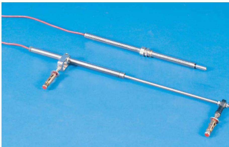
Fot.19.4. Szczelinomierz elektroniczny
