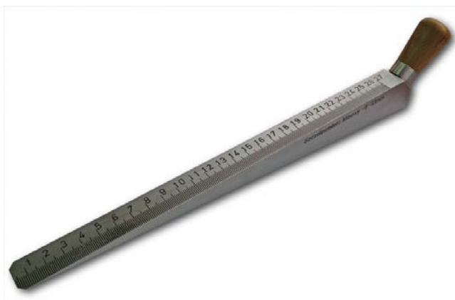
Fot.19.3. Szczelinomierz do ręcznego pomiaru rozwarcia szczelin
