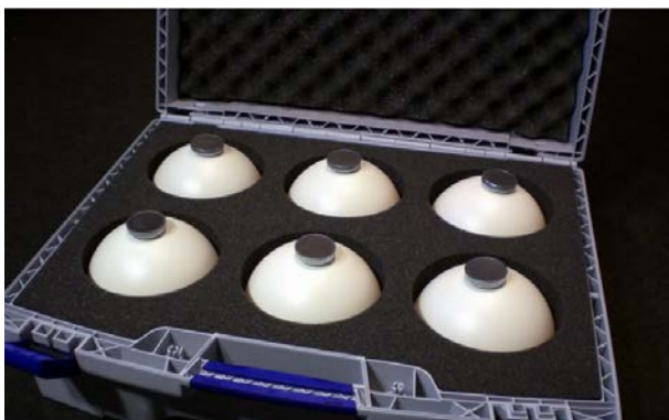
Fot. 19. 5. Zestaw sfer referencyjnych do pomiarów skanerem laserowym
