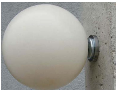
Fot. 19.9. Mocowanie sfery referencyjnej na magnetycznej podstawie
