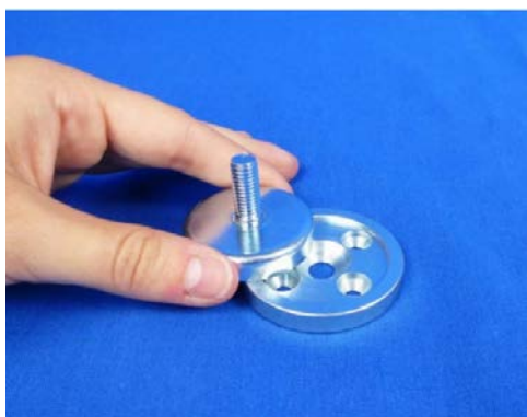
Fot. 19.7. Dopasowanie magnetycznej podstawy sfery do metalowego dysku mocującego
